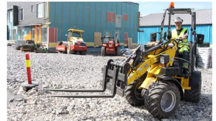
ELEKTRISK: Snøkker Anders Schullström tester ut en elektrisk hjullaster på Teglværkstomta i Oslo. Det finnes foreløpig ikke mange av dem, men trolig blir det flere slike å se på byggeplassene fremover. FOTO: TRINE BRÅTHEN / NRK
